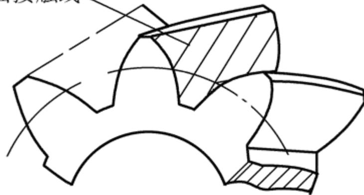
当发生面沿基圆柱作纯滚动时，直线 $BB$ 形成的一个螺旋形的渐开线曲面，称为**渐开线螺旋面**。
