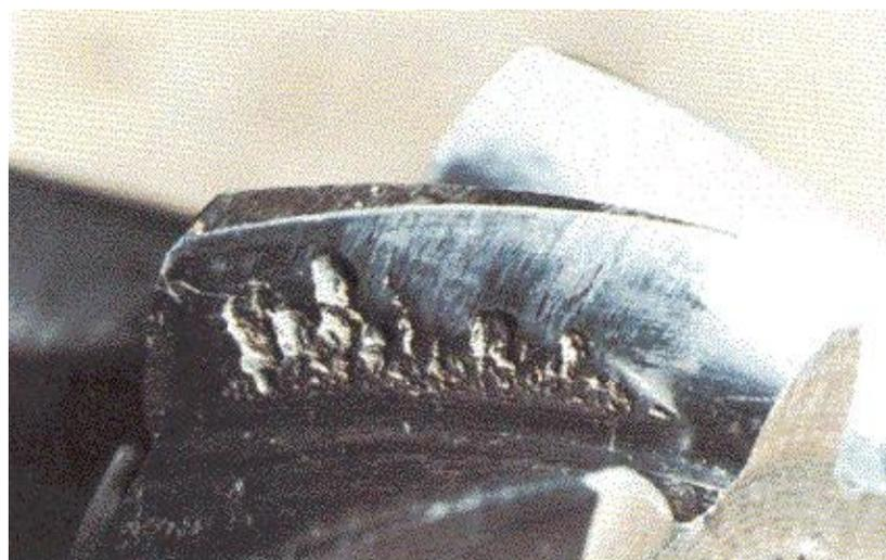
点蚀多发生在靠近节线的齿根面上。
