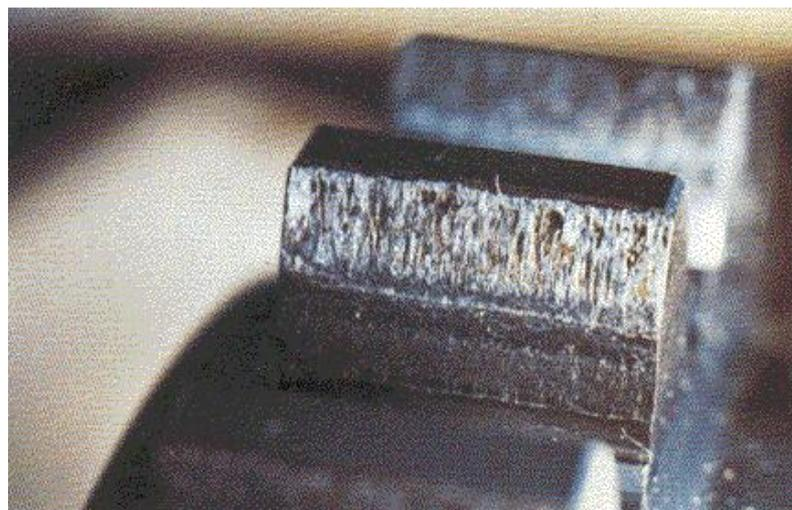
高速和低速重载的齿轮传动，容易发生齿面胶合。
